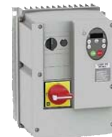
NFU-Geräte sind Frequenzumrichter mit Motorabgang im IP 54-Gehäuse für Wandmontage, bestückt mit Hauptschalter, Drehrichtungswahlschalter und Sollwertpotentiometer.
